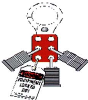
图1 同一隔离点多个锁定
