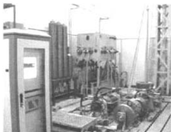
图 3 二次调节流量耦联系统测试试验台照片
